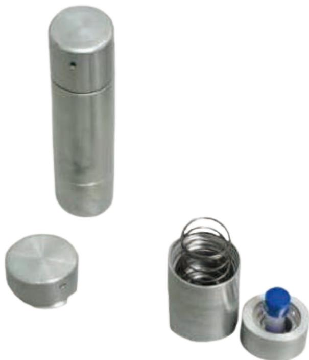
Dispositivo de desafio de processo para esterilizador a **vapor**
